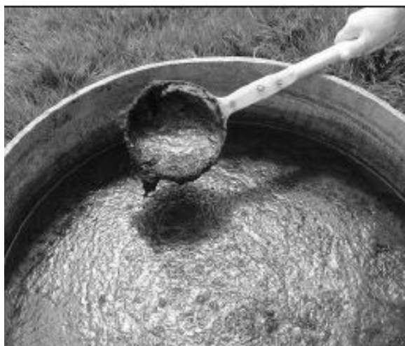
Figura 12 – exemplo de lodo denso (granular)
