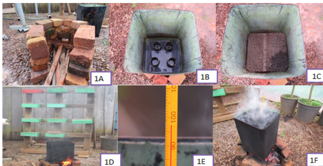
Figura 1: Passo a passo para a construção do protótipo de um esterilizador de substrato.
