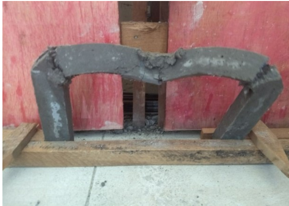
Figura 3: O pórtico sendo atingido na altura de 2,0m. Rompimento total
