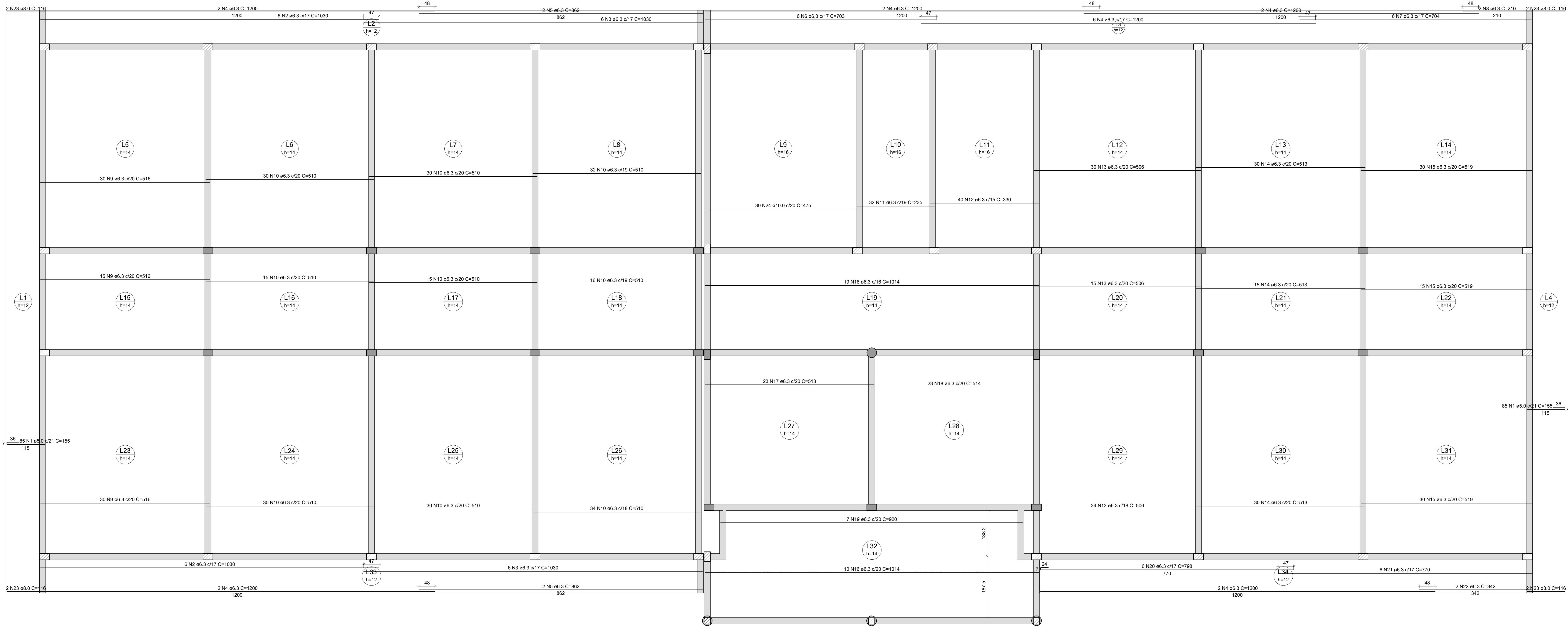
Armação positiva das lajes do pavimento LAJE (Eixo X) escala 1:50
