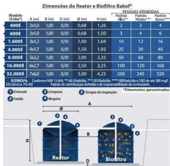
Figura- Sistema de tratamento reator e bio filtro 32.000 litros Referência Bakof tec
